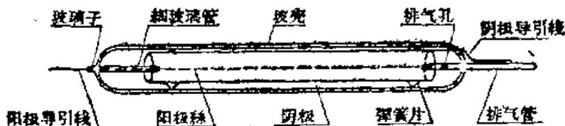
图 2-1 計数管的结构
